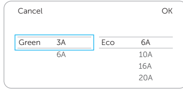
Şekil 9-10 Green modu için şarj akımı seviyesi
